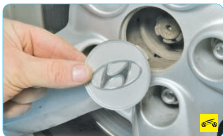
8. ...и снимите колпак гайки ступицы колеса.
