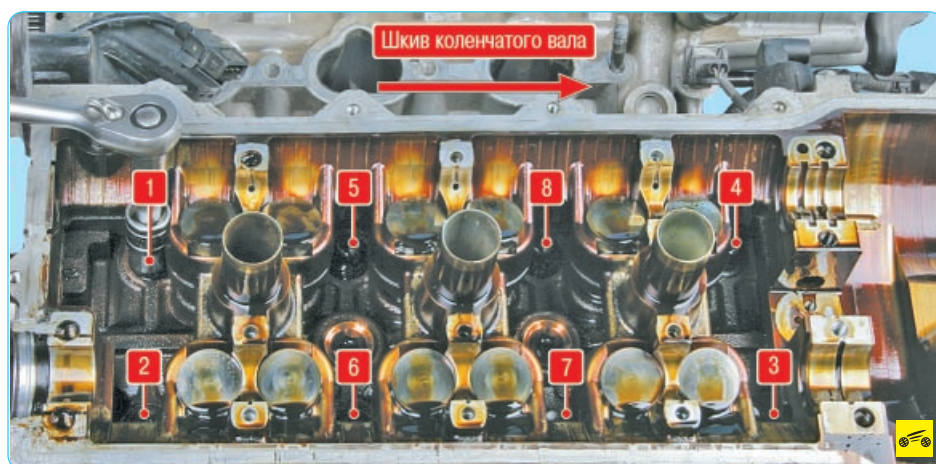
Рис. 5.8. Порядок ослабления затяжки болтов крепления задней головки блока цилиндров
