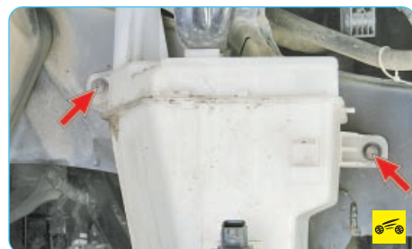
9. Выверните два болта крепления бачка к кузову.
