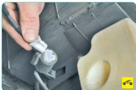
Рис. 11.8. Расположение пистонов крепления обивки передней двери (вид с внутренней стороны)
