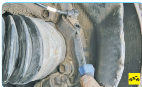
17. Подденьте датчик отверткой...
