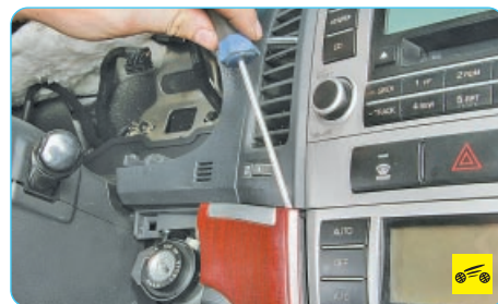
37. Подденьте край декоративной накладки панели приборов...
