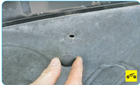
Рис. 11.6. Расположение пистонов крепления обивки капота
