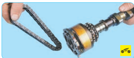
11. ...и цепь привода распределительных валов.
