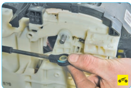
15. Отсоедините наконечник троса от рычага управления.
