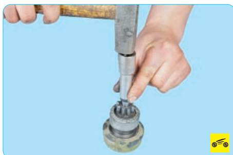
18. Сдвиньте ограничительное кольцо по валу ротора.
