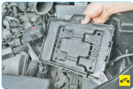
17. Снимите полку крепления аккумуляторной батареи.
