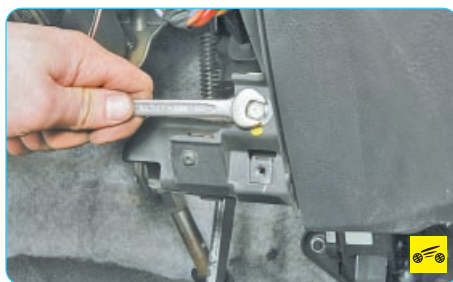
34. ...выверните болт, расположенный за левой нижней облицовкой панели приборов, в правой части...
