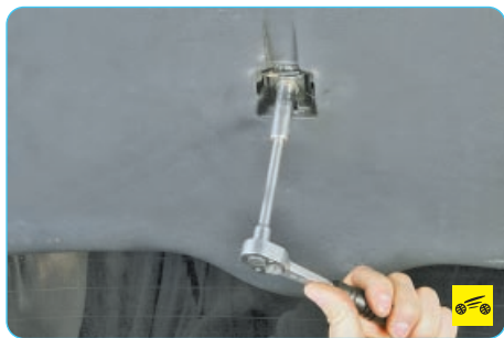
Рис. 11.7. Расположение пистонов крепления нижней облицовки двери задка (вид с внутренней стороны)
