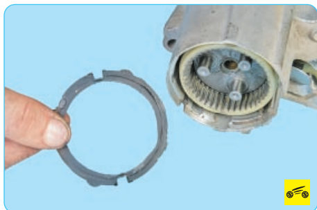
14. Снимите уплотнительное кольцо с коронной шестерни планетарного редуктора.
