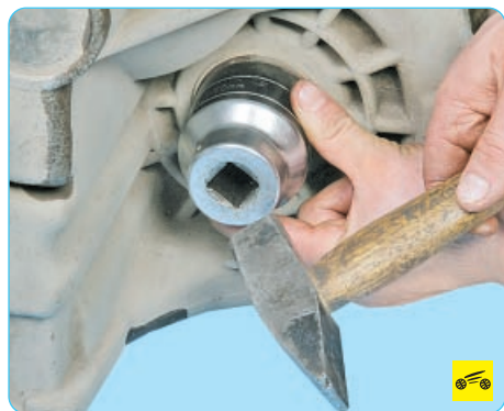
3. Извлеките сальник отверткой.
