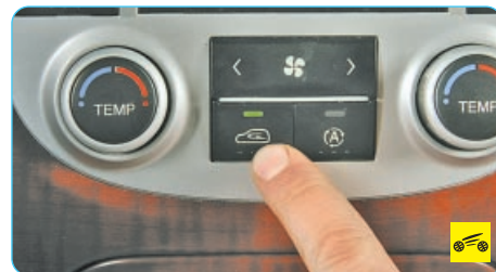
Рис. 1.11. Блок управления системой отопления, кондиционирования и вентиляции: 1 – клавиша включения автоматического режима; 2 – клавиша выключения системы отопления, кондиционирования и вентиляции; 3 – дисплей; 4, 5 – клавиши выбора направления распределения воздушных потоков в салоне; 6 – клавиша выбора режима регулировки температуры салона; 7 – ручка регулятора температуры правой части салона; 8 – клавиша включения автоматического режима рециркуляции; 9 – клавиша регулятора скорости вращения вентилятора; 10 – клавиша включения/выключения режима рециркуляции воздуха; 11 – ручка регулятора температуры левой части салона; 12 – клавиша включения кондиционера
