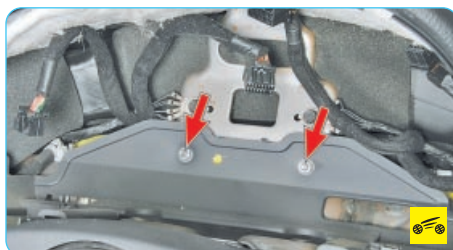
33. Отверните две гайки крепления панели приборов, расположенные за комбинацией приборов...
