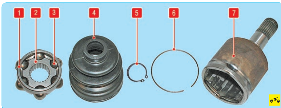
Рис. 6.23. Детали внутреннего шарнира привода задних и левого переднего колес: 1 – сепаратор; 2 – обойма; 3 – шарик; 4 – чехол; 5 – стопорное кольцо корпуса; 6 – стопорное кольцо обоймы; 7 – корпус
