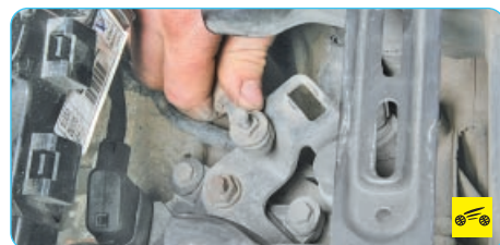
12. Отсоедините наконечник троса управления коробкой передач от рычага на коробке передач (см. «Регулировка и замена троса управления автоматической коробкой передач», с. 138).
