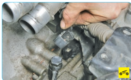
8. Аналогично отсоедините колодки от датчика частоты вращения ведущего вала...
