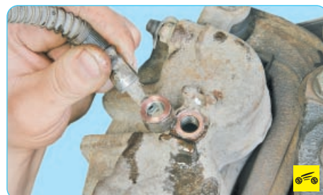
8. Отсоедините наконечник шланга от рабочего цилиндра.
