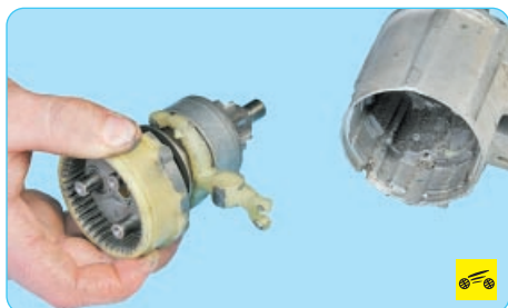
16. Извлеките из передней крышки вал привода в сборе с муфтой свободного хода и рычагом привода.
