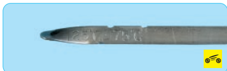
6. Уровень жидкости должен находиться между метками в виде насечек, которые соответствуют минимальному и максимальному уровням по шкале «75 °C» на щупе.
