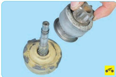
22. Снимите с вала привода муфту свободного хода...
