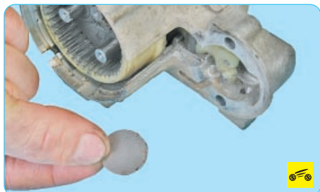
15. Снимите пластину с передней крышки.
