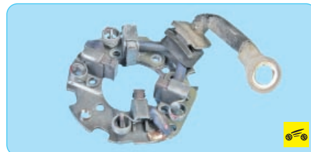
25. Осмотрите щеточный узел. Проверьте высоту щеток в щеткодержателе. Если их высота 7 мм и менее, замените щеточный узел новым.
