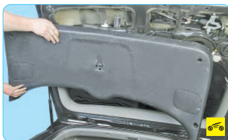
Рис. 11.7. Расположение пистонов крепления нижней облицовки двери задка (вид с внутренней стороны)
