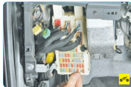
Рис. 10.2. Предохранители, плавкие вставки, перемычки и реле в монтажном блоке, расположенном в моторном отсеке
