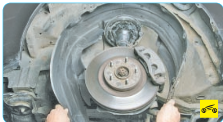
Рис. 11.1. Расположение пистонов верхнего крепления переднего подкрылка
