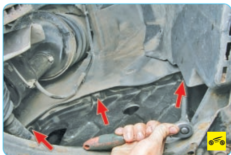
6. Для снятия правого брызговика двигателя выверните три верхних болта крепления...
