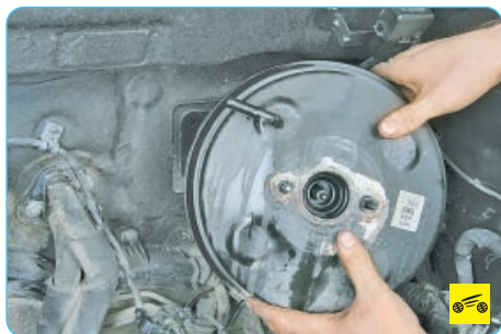
12. Снимите вакуумный усилитель тормозов.
