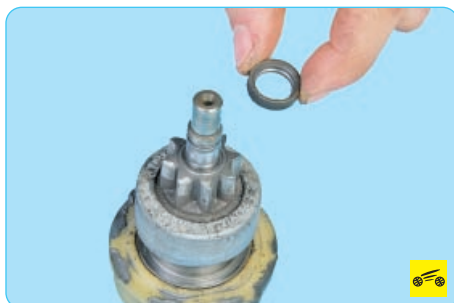
21. Сдвиньте обратно ограничительное кольцо и снимите его с вала привода.
