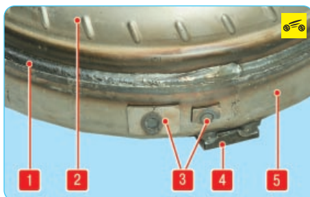
Рис. 6.14. Гидротрансформатор: 1 – сборочный сварной шов корпуса; 2 – задняя часть корпуса; 3 – балансирующие грузики; 4 – установочный кронштейн; 5 – передняя часть корпуса
