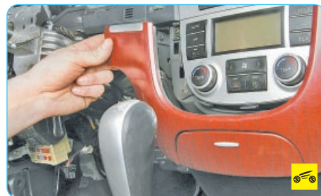
38. ...и, преодолевая сопротивление фиксаторов крепления, отведите накладку от панели.
