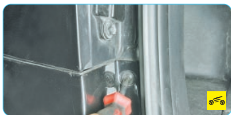
Рис. 11.5. Крепление нижней облицовки радиатора: А – фиксатор крепления; Б – винт крепления
