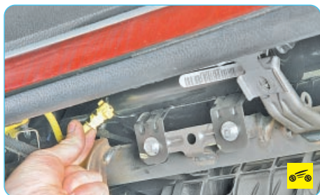
29. Отожмите фиксатор и отсоедините колодку жгута проводов от модуля подушки безопасности переднего пассажира.
