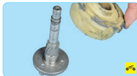
23. ...и коронную шестерню планетарного редуктора.
