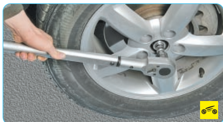
9. Ослабьте затяжку гайки ступицы.
