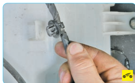
5. Снимите держатель жгута проводов с кронштейна на бачке.
