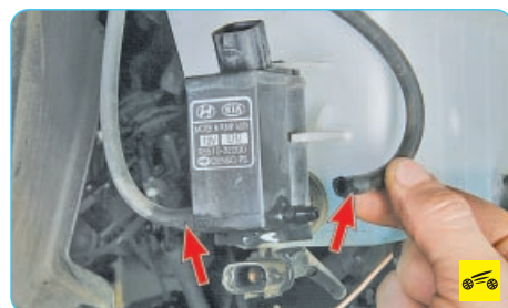
7. Отсоедините шланги от штуцеров электронасоса.
