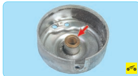
24. Осмотрите заднюю крышку. Если втулка в крышке изношена или на ней появились задиры, раковины и другие дефекты, замените крышку в сборе с втулкой.
