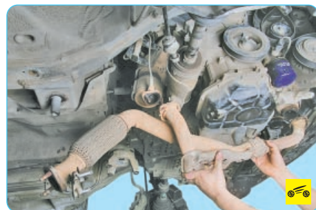
15. Снимите приемную трубу (см. «Снятие и установка приемной трубы», с. 100).
