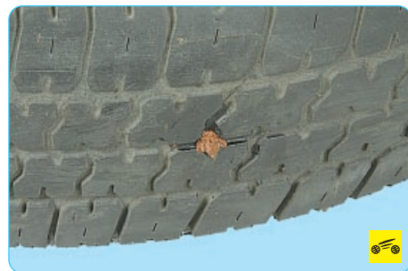
13. Подождите указанное в прилагаемой к ремонтному набору инструкции время, необходимое для полимеризации клея, и доведите давление в шине до рекомендуемого.
