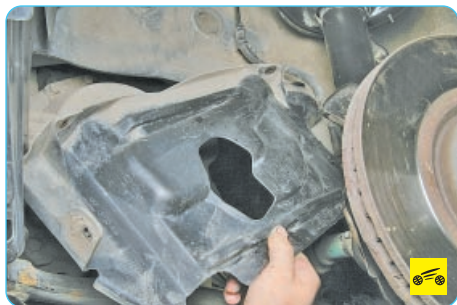
5. Снимите левый брызговик двигателя.
