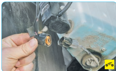
3. Сожмите фиксатор колодки жгута проводов и разъедините колодки датчика выключателя сигнализатора недостаточного уровня жидкости в бачке омывателей.
