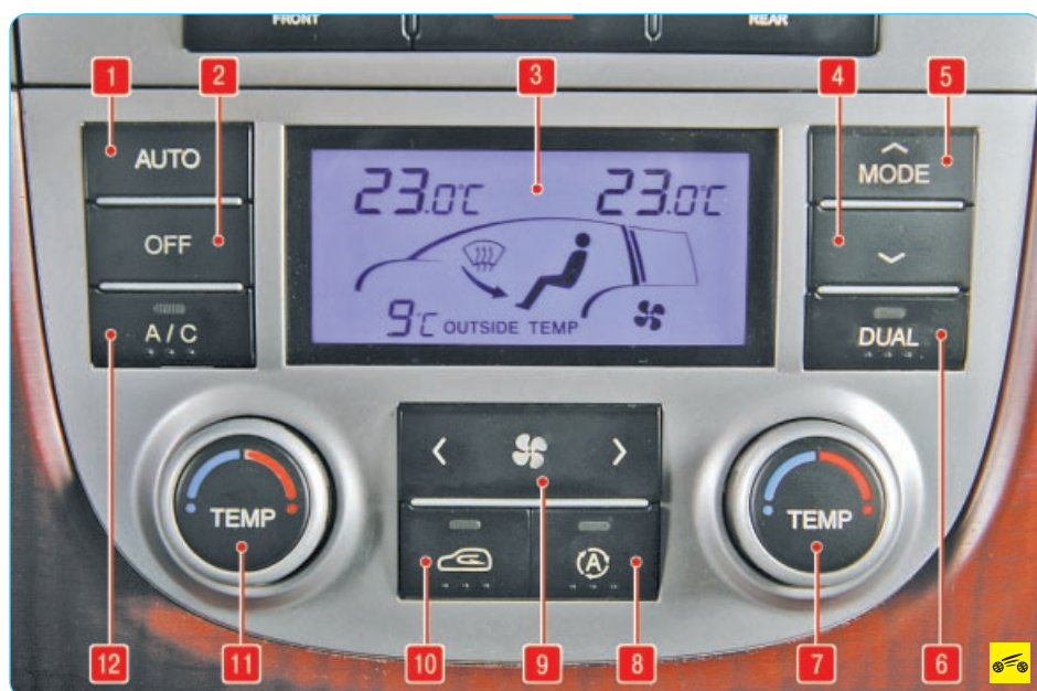
Рис. 1.11. Блок управления системой отопления, кондиционирования и вентиляции: 1 – клавиша включения автоматического режима; 2 – клавиша выключения системы отопления, кондиционирования и вентиляции; 3 – дисплей; 4, 5 – клавиши выбора направления распределения воздушных потоков в салоне; 6 – клавиша выбора режима регулировки температуры салона; 7 – ручка регулятора температуры правой части салона; 8 – клавиша включения автоматического режима рециркуляции; 9 – клавиша регулятора скорости вращения вентилятора; 10 – клавиша включения/выключения режима рециркуляции воздуха; 11 – ручка регулятора температуры левой части салона; 12 – клавиша включения кондиционера
