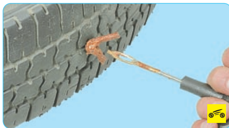
11. Резко выдерните иглу из отверстия.
