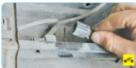
Рис. 11.5. Крепление нижней облицовки радиатора: А – фиксатор крепления; Б – винт крепления
