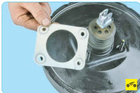
13. Замените уплотнительную прокладку.
