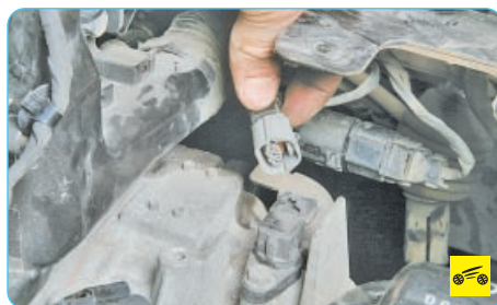
7. ...и отсоедините колодку жгута проводов от датчика частоты вращения ведомого вала.
