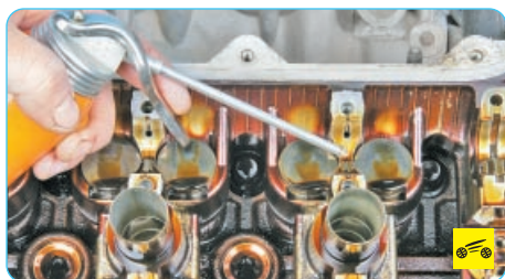
14. Смажьте постели распределительных валов чистым моторным маслом.
