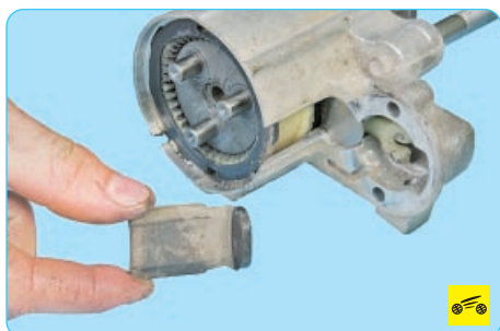
13. Снимите резиновое уплотнение с передней крышки.
