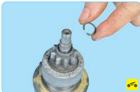
20. ...и снимите его с вала привода.
