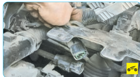
11. ...и от датчика скорости автомобиля.
