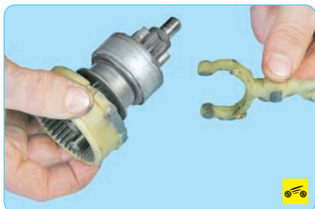
17. Снимите рычаг привода с муфты свободного хода.
