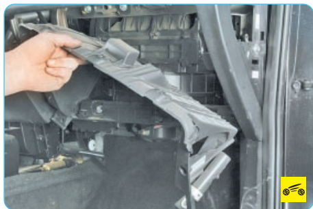
26. Отведите в сторону корпус вещевого ящика.
