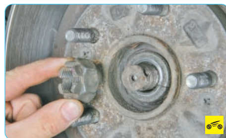
20. Отверните гайку ступицы и снимите ее.
