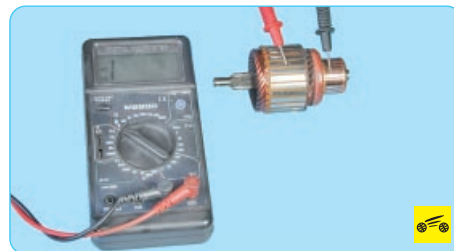
27. Проверьте омметром каждую обмотку ротора на короткое замыкание.
