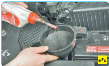
7. Если уровень жидкости приближается к нижней границе шкалы «75 °C» или ниже ее, долейте жидкость. Рабочую жидкость доливают через трубку указателя уровня
