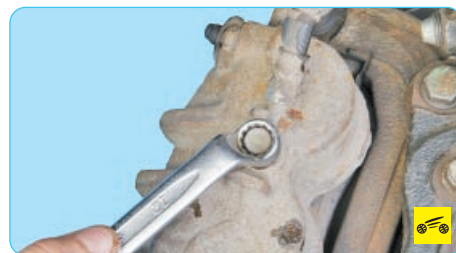
7. Выверните болт-штуцер крепления наконечника тормозного шланга к рабочему цилиндру.
