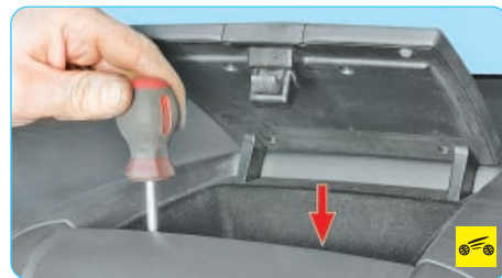
41. Выверните два винта крепления вещевого отсека для мелких предметов...
