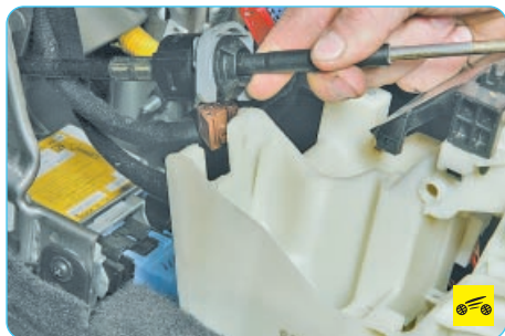
17. ...и выньте трос из отверстия в корпусе кулисы рычага управления.
