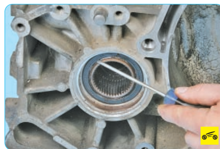
3. Извлеките сальник отверткой.
