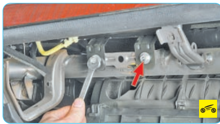
30. Выверните два болта крепления панели приборов, расположенные в верхней части ниши корпуса вещевого ящика.
