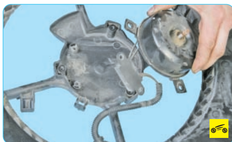
9. Снимите заменяемый электродвигатель в сборе с дополнительным сопротивлением с кожуха.
