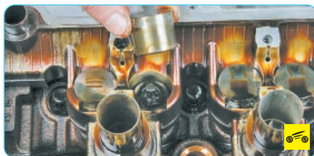
1. Снимите толкатели клапанов.
