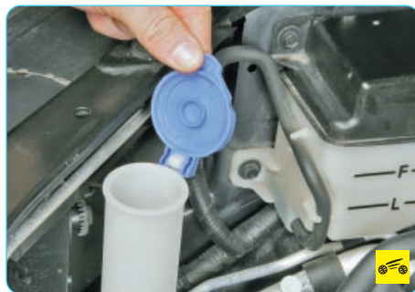
7. Если уровень жидкости приближается к нижней границе шкалы «75 °C» или ниже ее, долейте жидкость. Рабочую жидкость доливают через трубку указателя уровня
