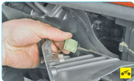
27. Отсоедините колодку жгута проводов от выключателя вещевого ящика.
