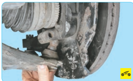
8. ...и снимите колпак гайки ступицы колеса.
