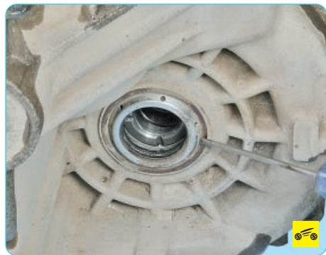
3. Извлеките сальник отверткой.
