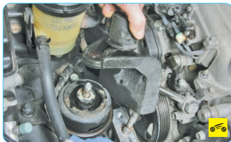
6. Для снятия правого брызговика двигателя выверните три верхних болта крепления...
