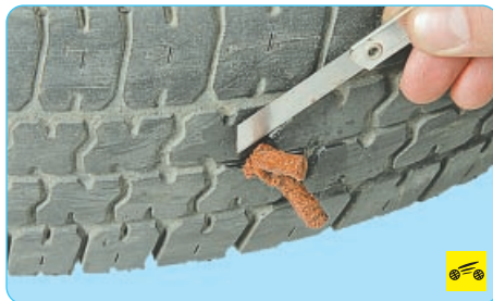
12. Обрежьте оставшиеся на поверхности концы жгута в уровень протектора.
