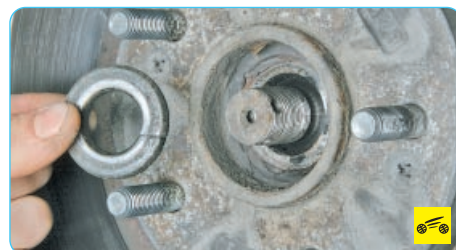
20. Отверните гайку ступицы и снимите ее.
