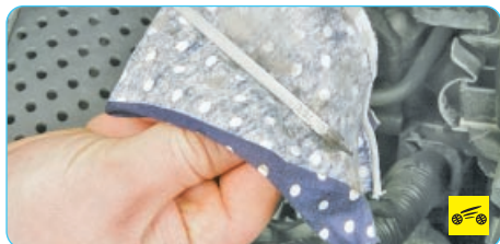
5. ...протрите обтирочной тканью и установите на место. Повторно выньте указатель (щуп).
