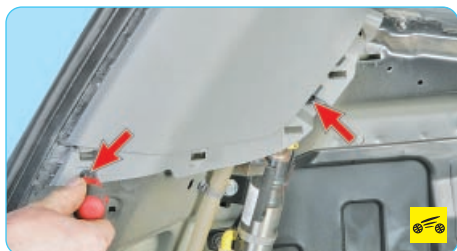
Рис. 11.10. Крепление боковой облицовки багажного отделения: А – фиксатор крепления; Б – пистон крепления
