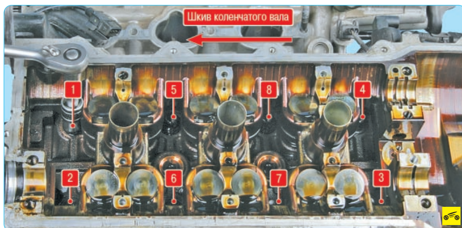
Рис. 5.7. Порядок ослабления затяжки болтов крепления передней головки блока цилиндров
